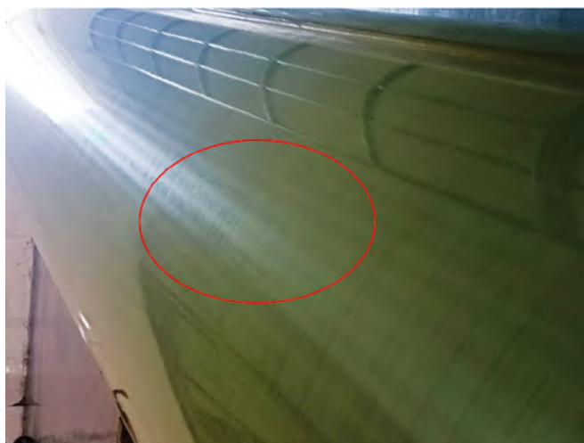
图1 辊面出现明显横纹
