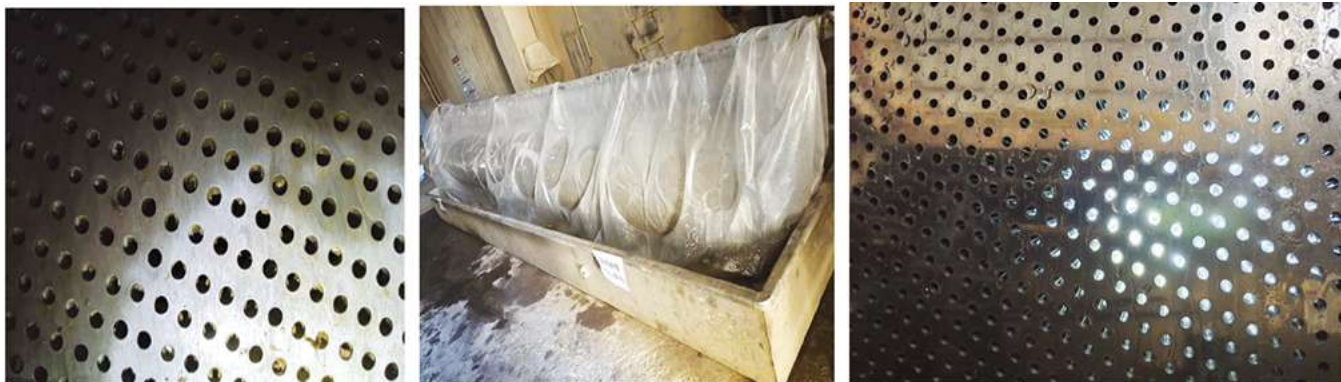
(a) 吸移辊辊面孔眼结垢堵塞照片
