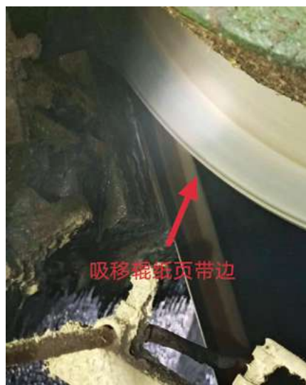
图6 吸移辊纸页带边
