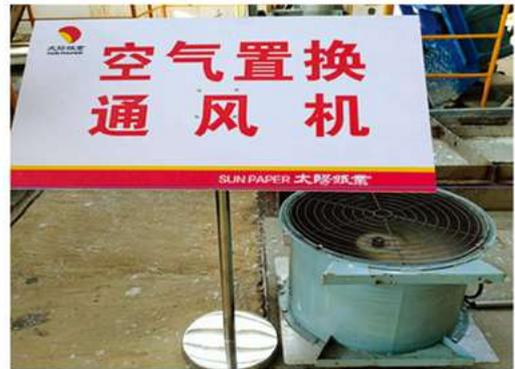
图6 有限空间上部安装空气置换通风机模块
