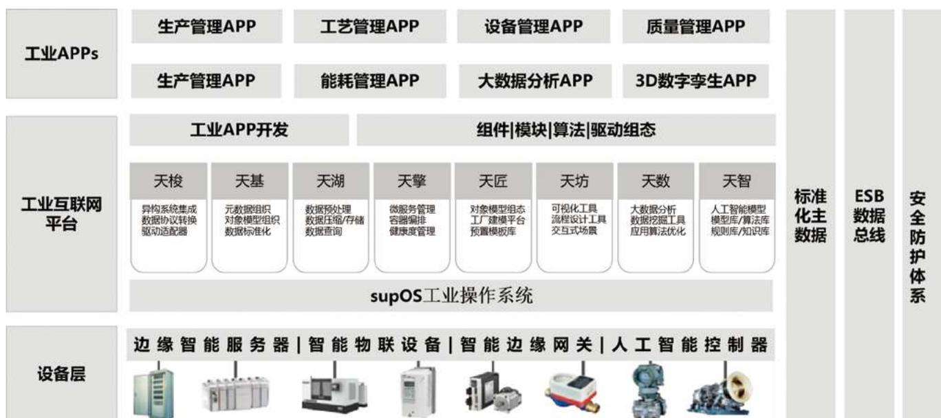
图1 工业互联网平台架构
