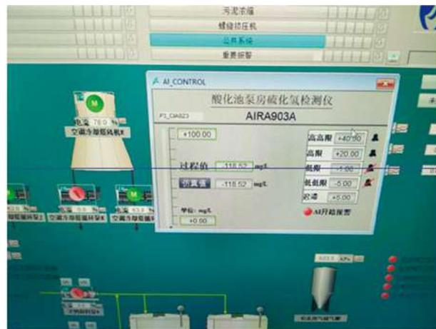
图10 车间主控室DCS界面安装有有毒有害气体在线实时检测数据程序
