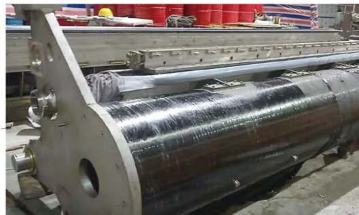
新型碳纤维刮刀梁 应用于江西五星纸业5600/1100白卡纸项目（国产设备首创）
