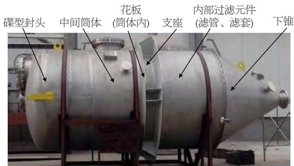
图1 白液精细过滤机结构
