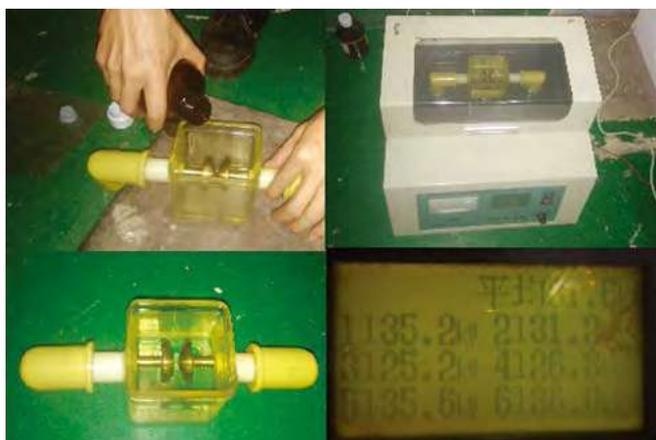
图2 对变压器油进行耐压检测
