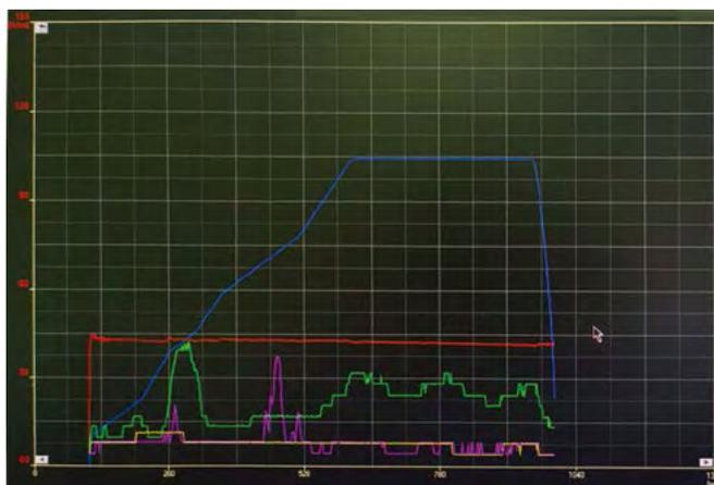
图15 车速1800m/min运行时的振动曲线
