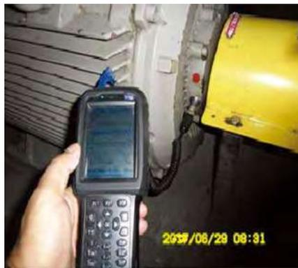
图13 电机运行中的振动监测
