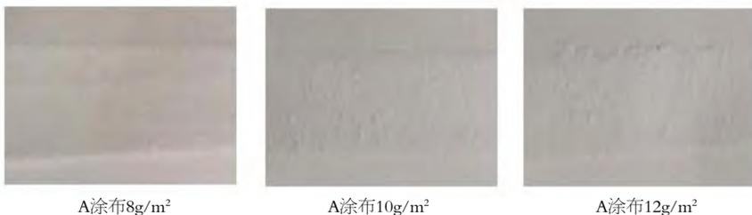
图4 进口无塑涂料A两次涂布揭开热封合处的情况
