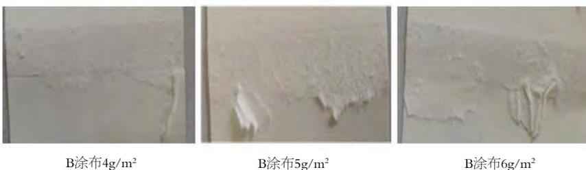
图5 进口无塑涂料B两次涂布揭开热封合处的情况
