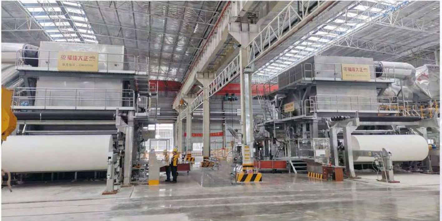
运行中的新月纸机，幅宽4200mm，车速1400m/min，抄造克重11g/m<sup>2</sup>
