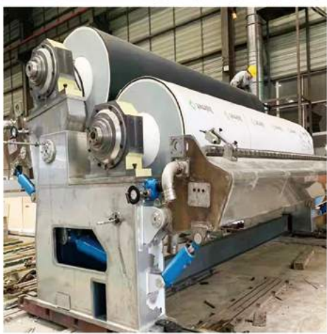
新型碳纤维刮刀梁 应用于江西五星纸业5600/1100白卡纸项目(国产设备首创)
