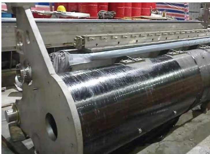
新型碳纤维刮刀梁 应用于江西五星纸业5600/1100白卡纸项目(国产设备首创)
