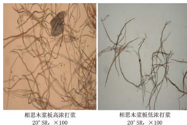
图4 高、低浓打浆处理后浆料的表面形貌差异
