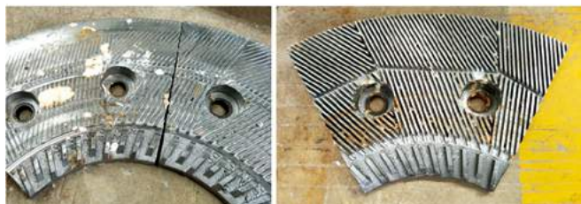
图3 两个磨区磨片磨损不均匀的情况
