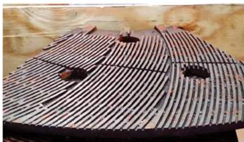
图4 48英寸粗粒多元合金磨片磨损均匀平整
