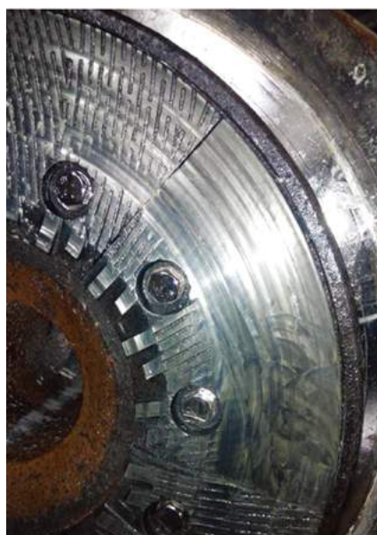
图4 同一个磨区磨片磨损不均匀的情况
