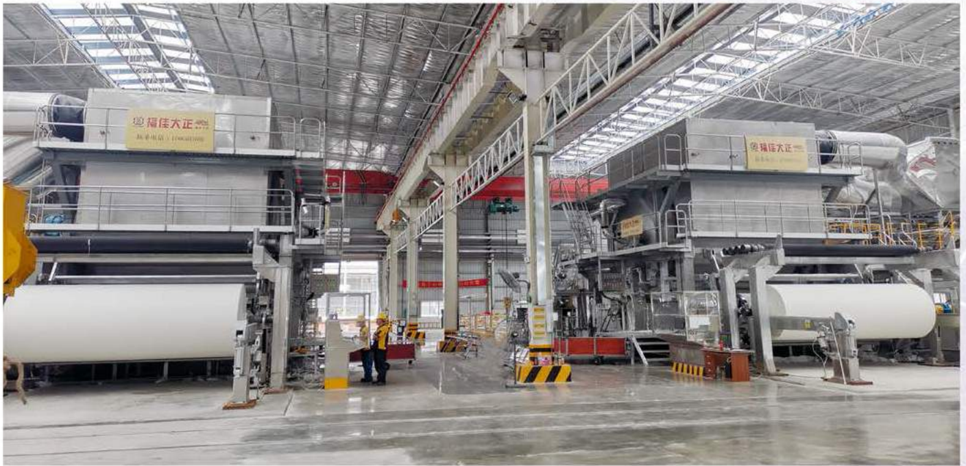
运行中的新月纸机，幅宽4200mm，车速1400m/min，抄造克重11g/m 2
